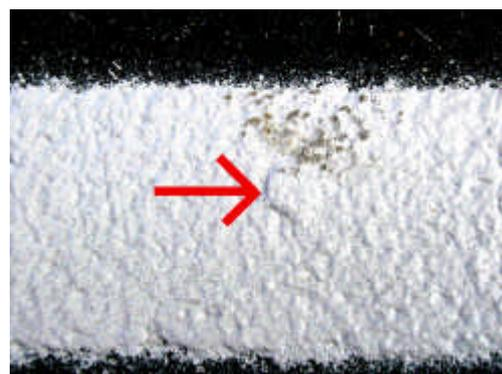
Fig. 5- Tinta termoplástica 1,5 mm/spray
