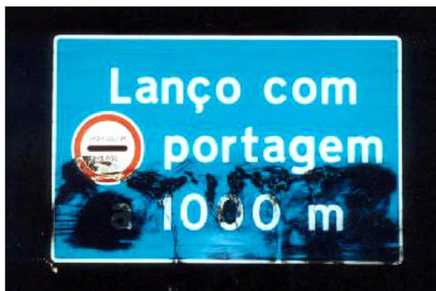
Fig. 9 a – efeito de limpeza com material abrasivo
