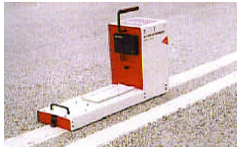
Fig. 3- Retroreflectómetro
