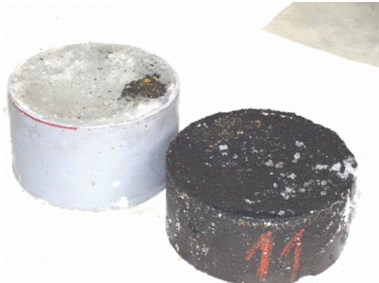
FOTO 4: Probeta con Grikol. Rotura en la interfaz hielo/asfalto
