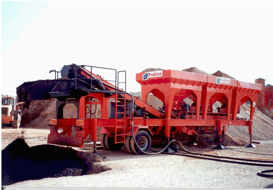
Foto1. Planta de fabricación de mezclas en frío
