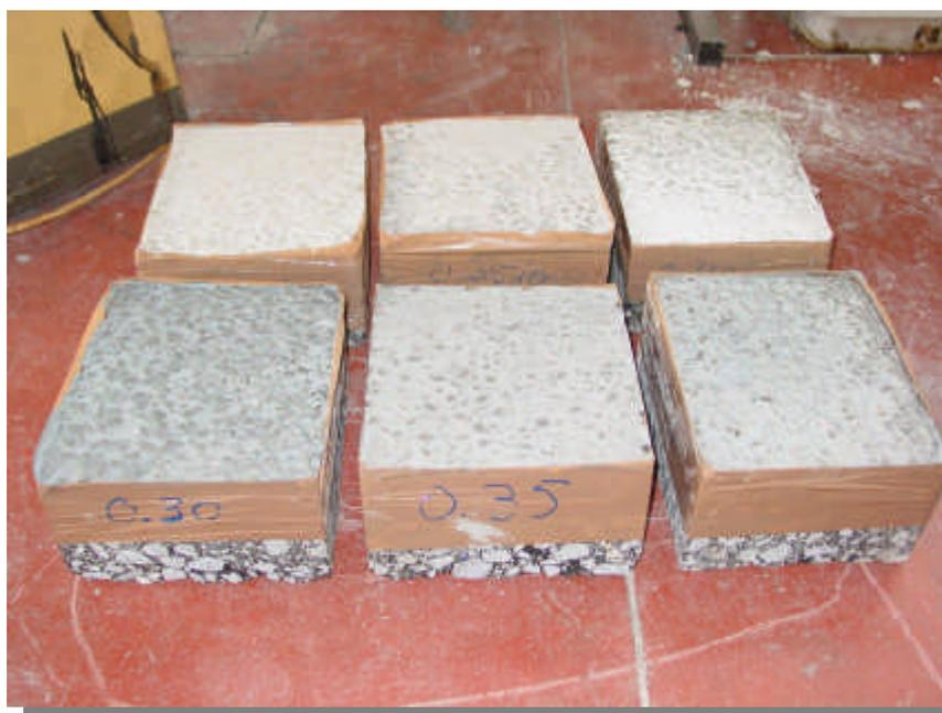
Figura 3 – Lajes preenchidas com calda de cimento
